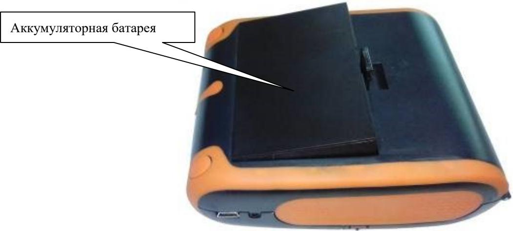
1. Потяните за выступ, откройте крышку аккумуляторного отсека, выньте батарею.
