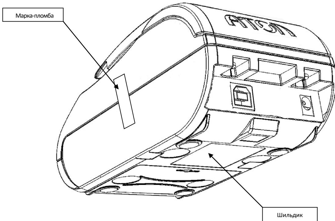
Один элемент марки-пломбы наклеивается на кожух, закрывающий блок управления и устройства печати кассовых чеков так, чтобы было невозможно получить доступ к внутренней части ККТ без разрушения марки-пломбы. Шильдик наклеивается на дно корпуса ККТ.
