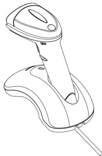
Убедитесь, что кабель подключен, установите сканер в подставку. Красный светодиод сканера горит во время зарядки и гаснет при полной зарядке. Время зарядки: около 3~4 часов.
