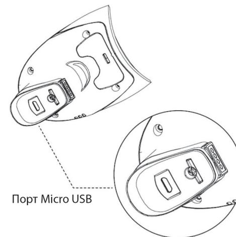
Вы можете зарядить сканер с помощью кабеля Micro USB из комплекта сканера. Красный светодиод сканера горит во время зарядки и гаснет при полной зарядке. Время зарядки: около 3~4 часов.
