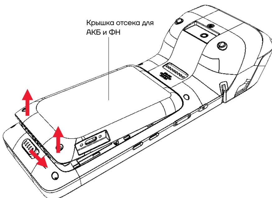
Рисунок 3. Открытие крышки отсека АКБ и ФН
