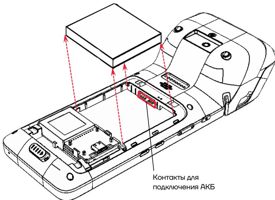
Рисунок 6. Извлечение АКБ из отсека
