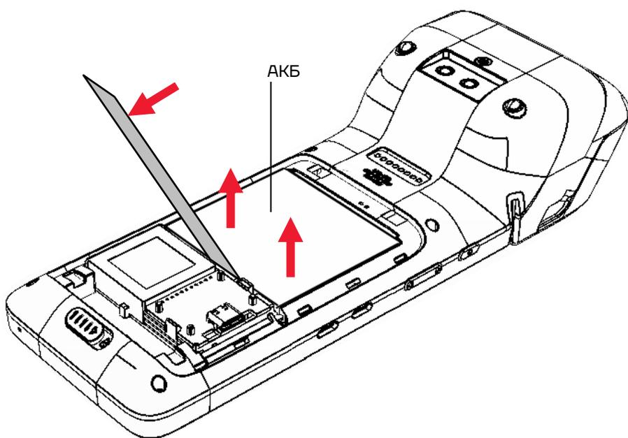
**6** Аккуратно поддеть АКБ тонким плоским предметом (рисунок 5), выдвинуть АКБ из отсека.
