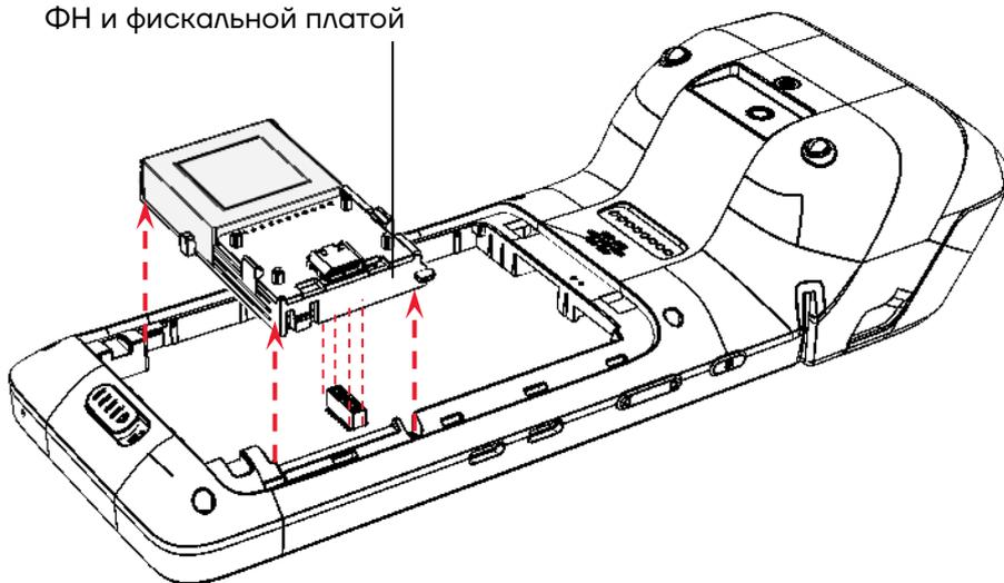
Рисунок 11. Извлечение держателя с ФН и фискальной платой из корпуса ККТ
