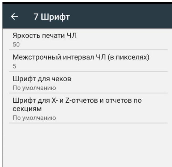
**Яркость печати ЧЛ.** В ККТ можно изменить яркость печати. Яркость печати может меняться при изменении температуры окружающей среды. Яркость при температуре воздуха +10 °С должна быть больше, чем при температуре +35 °С для того, чтобы на чеке изображение имело одинаковую яркость. Если печать производится нечасто и чеки короткие, то следует установить яркость больше, чем при интенсивной печати длинных чеков.
