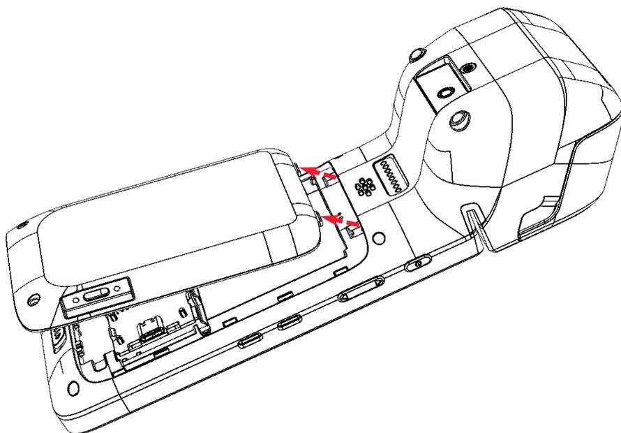
**5** Извлечь крышку отсека, учитывая положение выступов крышки.
