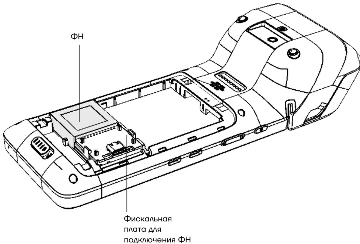
Рисунок 10. Расположение ФН в корпусе ККТ (крышка отсека условно не показана)
