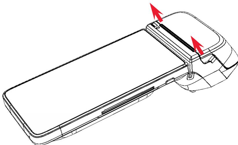
Рисунок 13. Направление приложения усилий при открытии крышки лотка для ЧЛ
