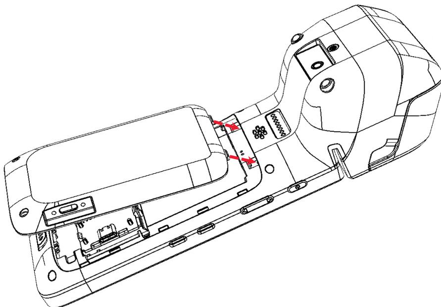
Рисунок 7. Установка крышки отсека для АКБ и ФН
