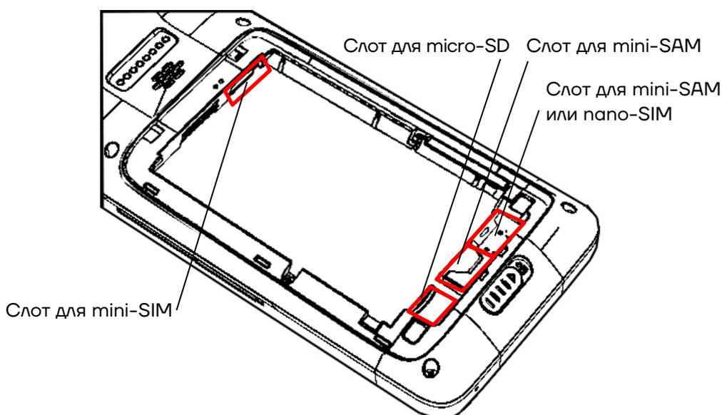
Рисунок 17. Расположение слотов для карт
