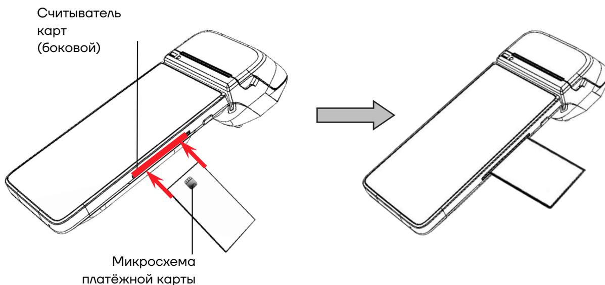
Рисунок 20. Оплата платёжной картой с использованием бокового устройства считывания
