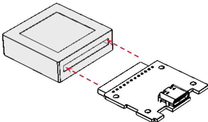
Рисунок 12. Отключение ФН от разъёма фискальной платы
