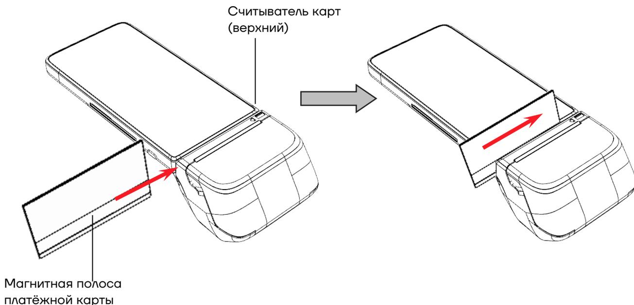
Рисунок 19. Оплата платёжной картой с использованием верхнего устройства считывания
