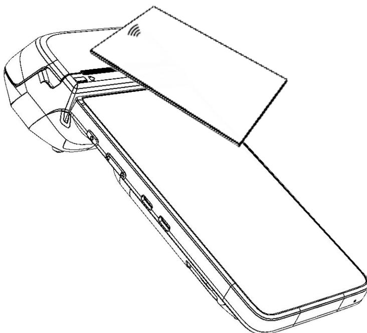
Рисунок 18. Оплата платёжной картой (бесконтактный способ)
