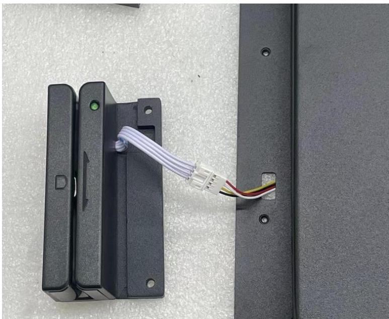
4. Закрепите MSR на моноблоке с помощью винтов 3\*8 мм.
